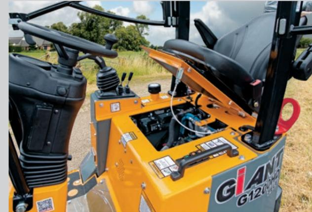
Es ist einfach, die regelmäßig wiederkehrenden Wartungsarbeiten beim G1100 und G1200 durchzuführen, da die Wartungspunkte gut erreichbar sind. Filter, Hydrauliksystem und Motor sind aufgrund der leicht zu öffnenden Haube und anderer Wartungskappen direkt zugänglich. Somit wird sichergestellt, dass die täglichen Überprüfungen und Wartungsarbeiten schnell und sicher durchgeführt werden können.
