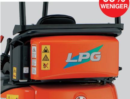
Im Vergleich zu den Dieselmotoren hat der Kubota Minibagger mit dem Gasmotorantrieb saubere Abgase und als Verbrennungsmotor fast keine Feinstaubpartikel. Zudem sind die NOx- und HC-Emissionen sehr niedrig, im Vergleich zu einem herkömmlichen Dieselmotor betragen diese nur 5 %.
